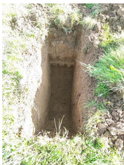
Cliché 1 : Creusement des fosses pour les essais Matsuo (crédit explor-e)
