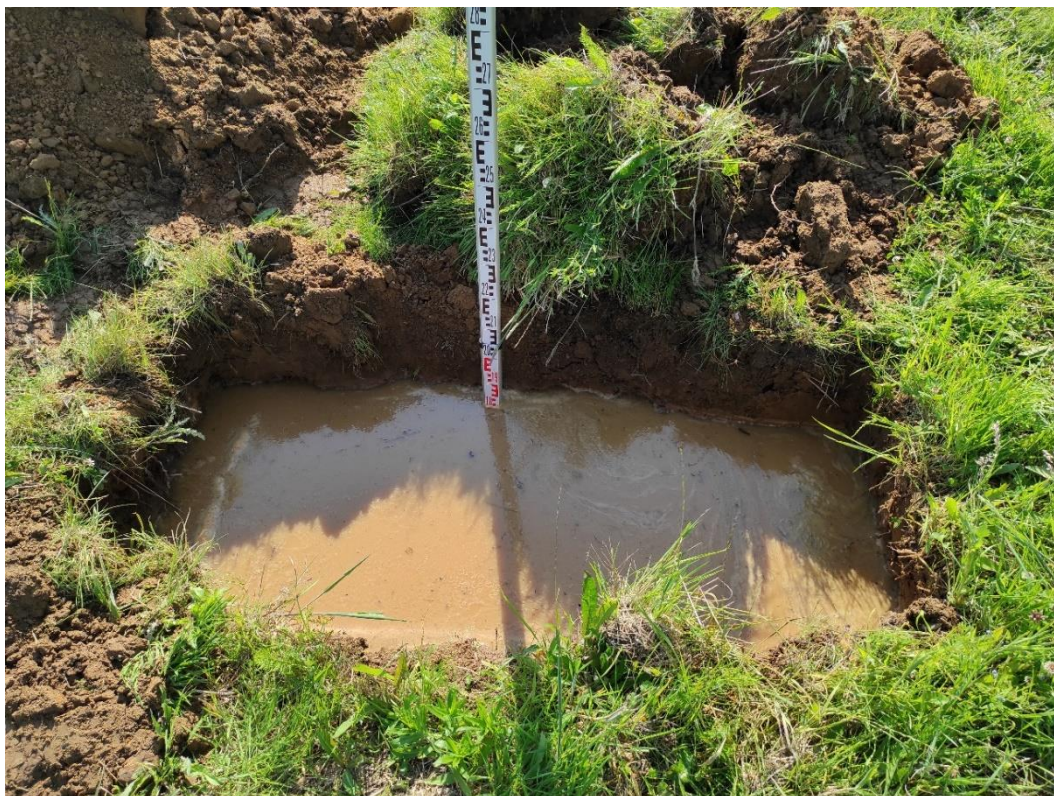
Cliché 2 : Photo de la fosse F1 remplie d'eau au début de l'essai Matsuo (crédit explor-e)
